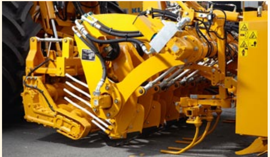
Hydraulisch angetriebenes Rodeaggregat mit Einzelschwingern.
