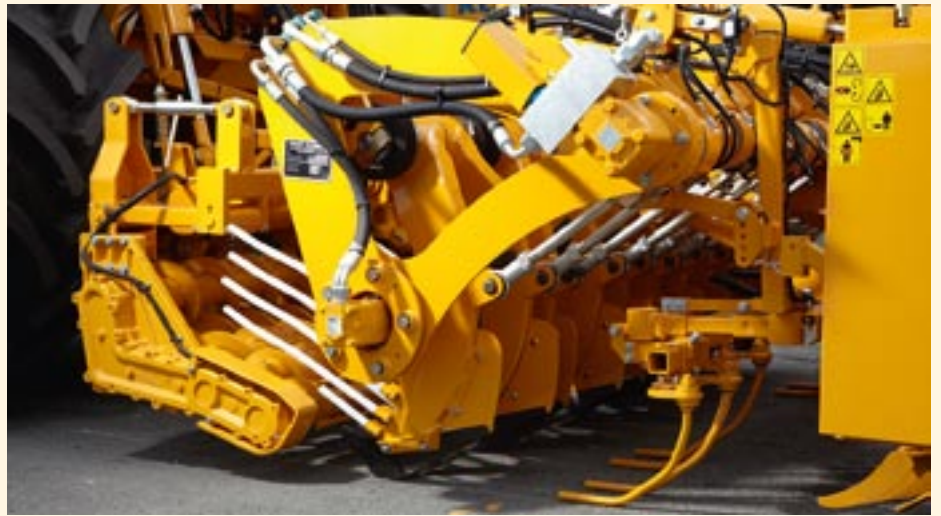
Groupe d'arrachage à entraînement hydraulique avec oscillateurs séparés. La vitesse se règle depuis la cabine.
