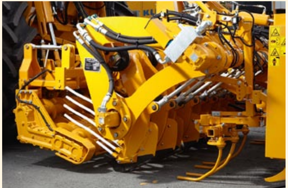
Agregat do zbioru buraków z napędem hydraulicznym z pojedynczym wibratorem.
